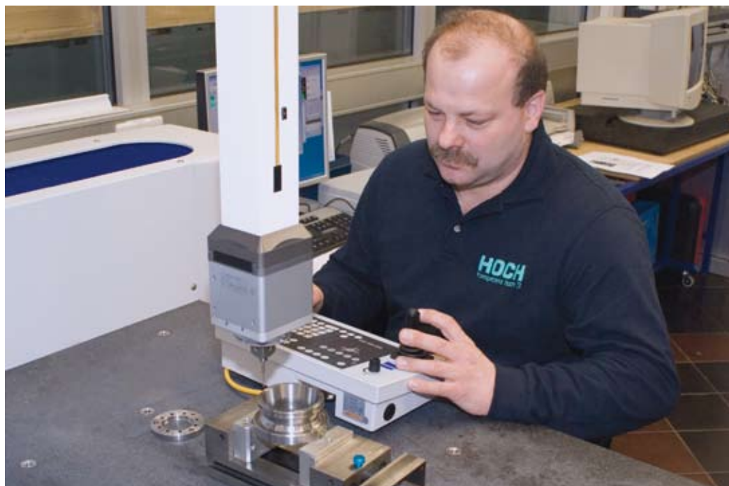
Bild 1: Thomas Hoch misst ein Drehteil mit CONTURA G2 und VAST XT.
